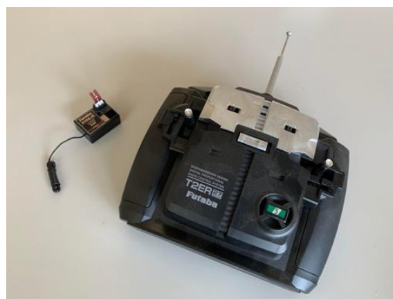
市售 3 通道 27MHz 板型遙控收發器
